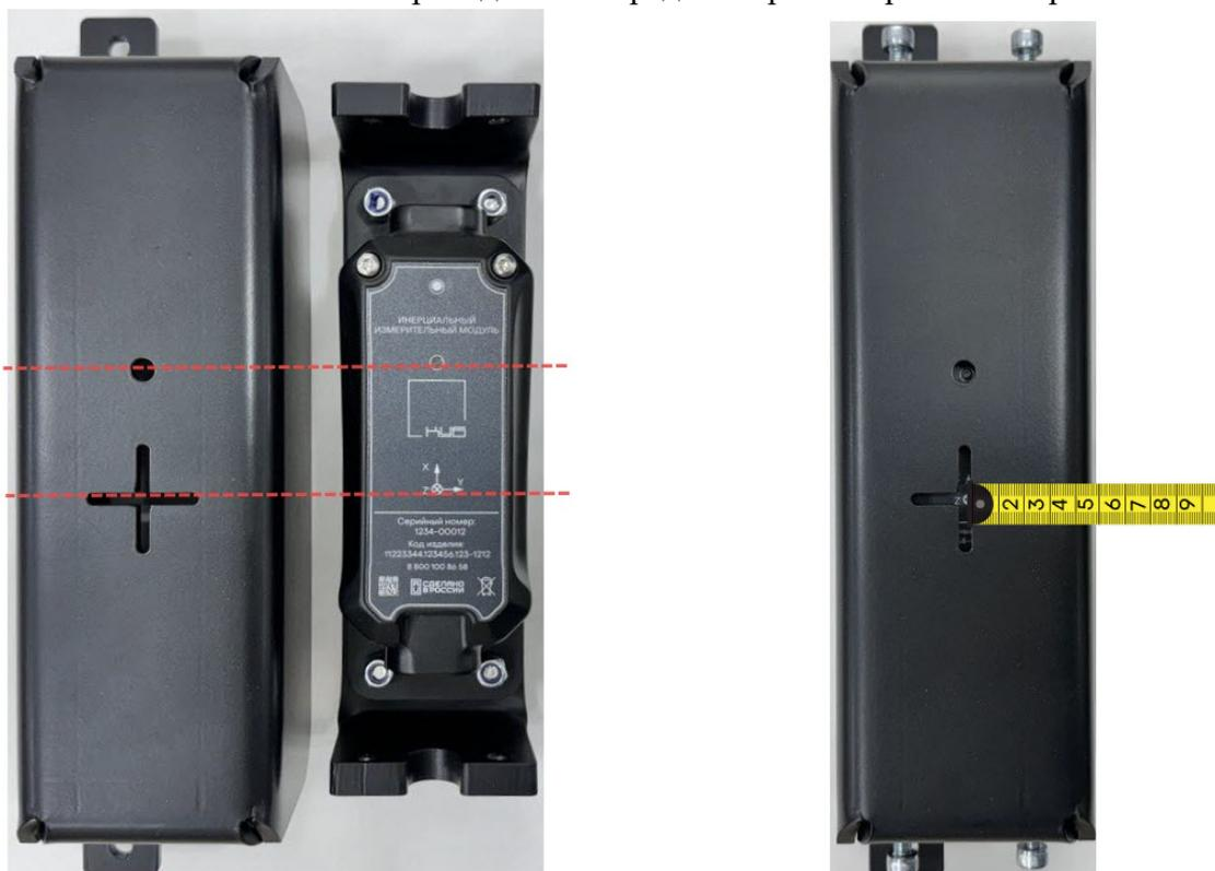
Рисунок 5. Начало отсчета ИИМ, установленного в кожух
