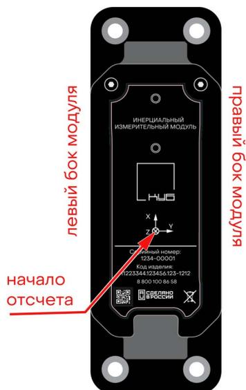
Рисунок 4. Начало отсчета инерциального измерительного модуля
