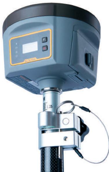
ГНСС-приемник SOUTH Galaxy G6 IMU основан на высокотехнологичном чипсете Trimble BD990 с поддержкой всех актуальных спутниковых систем, частотных диапазонов и сервисов дифференциальной коррекции. К важным преимуществам модели можно отнести практически мгновенную инициализацию в режиме RTK, мощные программные фильтры сигналов, высокую стабильность и качество данных. Все это позволяет проводить съемку точек в местах с большим количеством помех и районах с плохим покрытием ГНСС-сетей.
