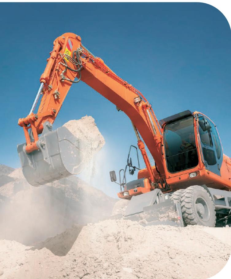
3D Система нивелирования, установленная на экскаватор, способствует повышению качества выполняемых работ, увеличивает скорость, позволяет снизить требования к профессионализму оператора машины. Качественное 3D позиционирование и курс для контроля ковша достигается за счет объединения высокоточной GNSS-антенны и двухосевых 100-герцовых инерциальных датчиков.
