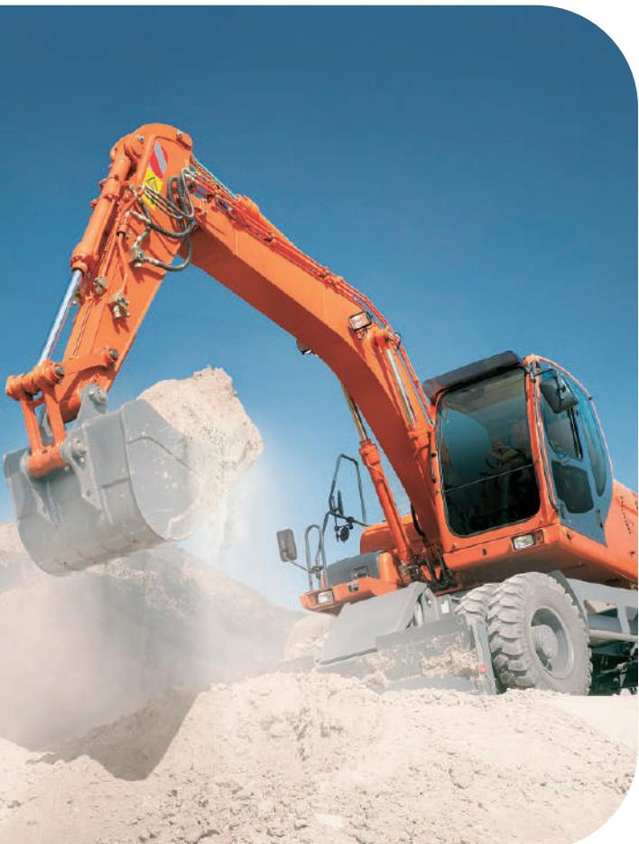
3D Система нивелирования, установленная на экскаватор, способствует повышению качества выполняемых работ, увеличивает скорость, позволяет снизить требования к профессионализму оператора машины. Качественное 3D позиционирование и курс для контроля ковша достигается за счет объединения высокоточной GNSS-антенны и двухосевых 100-герцовых инерциальных датчиков.
