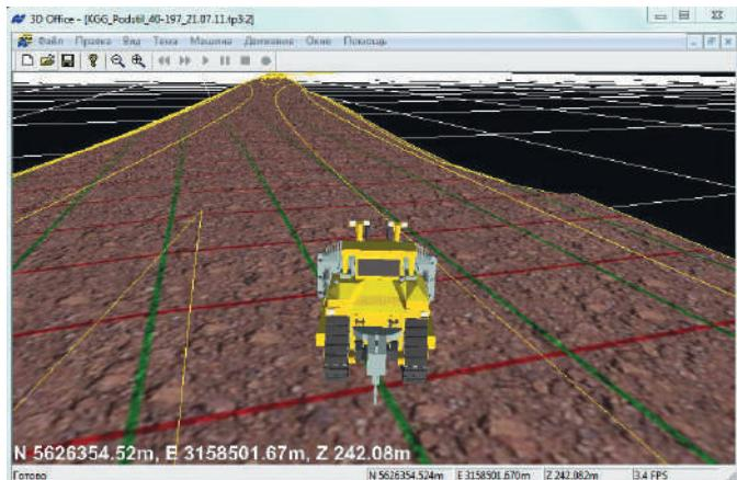
Задачи, решаемые с помощью программы Topcon 3D Office: импорт исходных данных, анализ реальной ситуации, создание или конвертирование 3D моделей, редактирование 3D моделей, создание контрольных точек (реперов).
